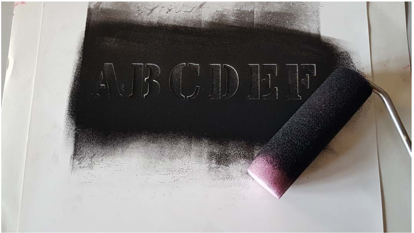
Schablone als Druckform mit Schaumstoffrolle, Schrift Stencil
