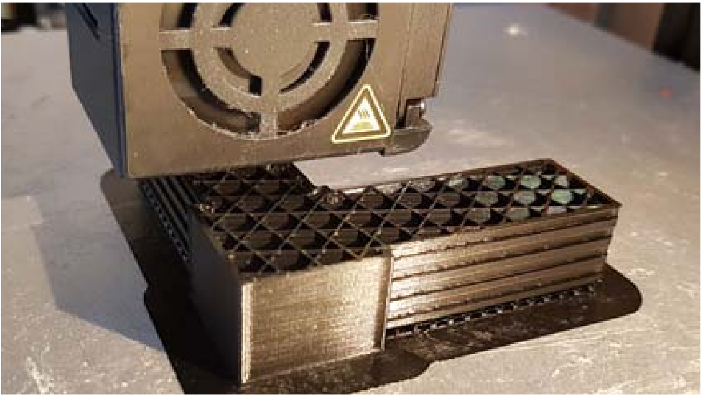
Selbst konstruierte und gedruckte Verbindung für Alu-Vierkantrohre
