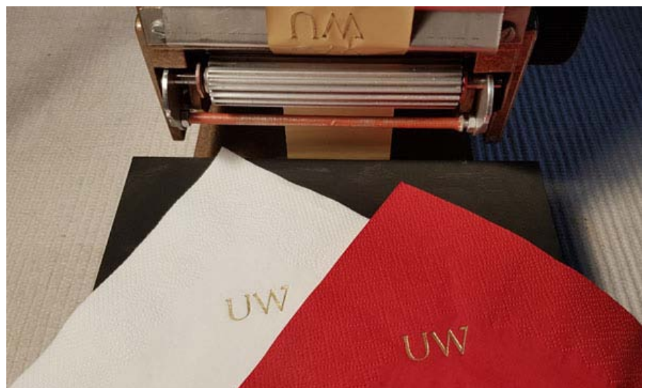
Die Transportrolle schiebt die Folie weiter, hier Druck auf Servietten
