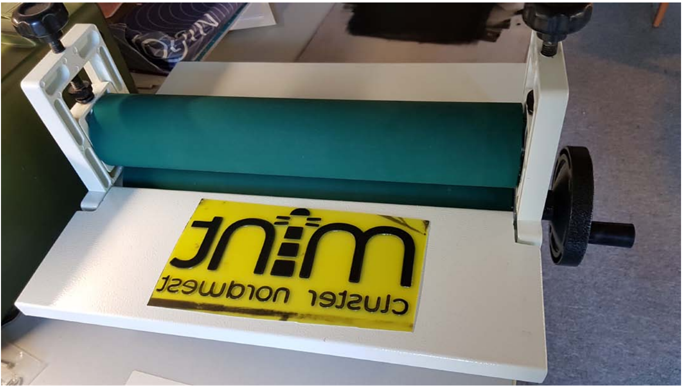
Fotopolymerplatte als Druckform auf der umfunktionierten Druckpresse (eigentlich ein Kaltlaminiiergerät)
