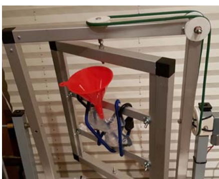
Gips in die Rotoformerform einfüllen
