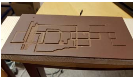
CNC Fräsestest einer Linoliumdruckform – noch per Handsteuerung
