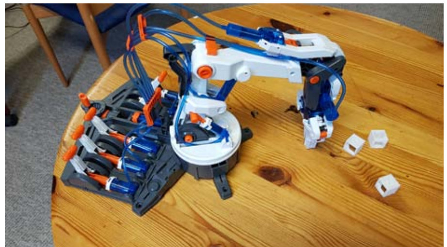
Der hydraulische Roboterarm, etwas fragil aber feinfühlig zu steuern
