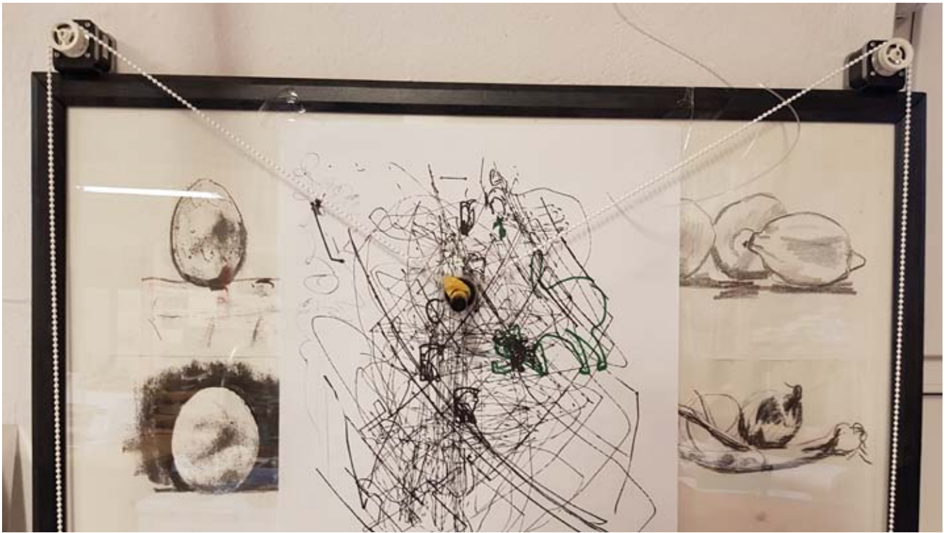
Polargraph oder Vertikalplotter auf einer Testseite
