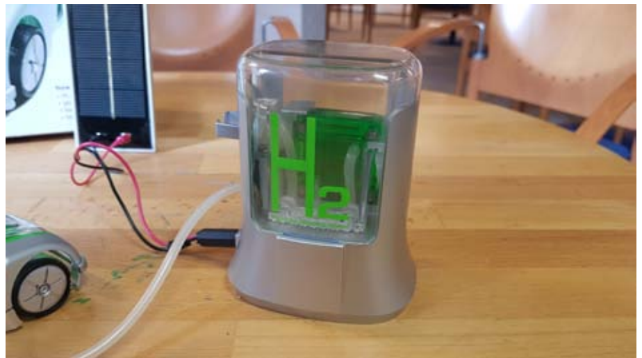
Die Wasserstoff-Tankstelle, betrieben mit einer Solarzelle (im Hintergrund)
