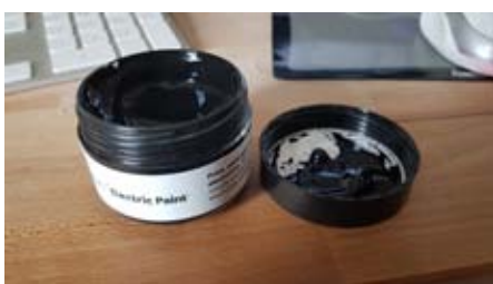
Hier die teure elektrisch leitfähig Siebdruckfarbe, für spezielle Experimente
