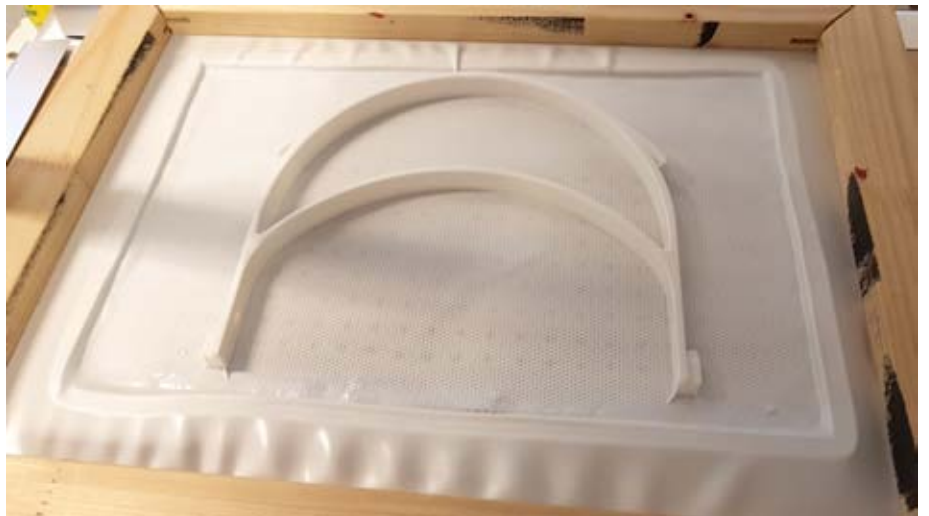
Formenherstellung eines Gestells mit dem Vacuum Former
