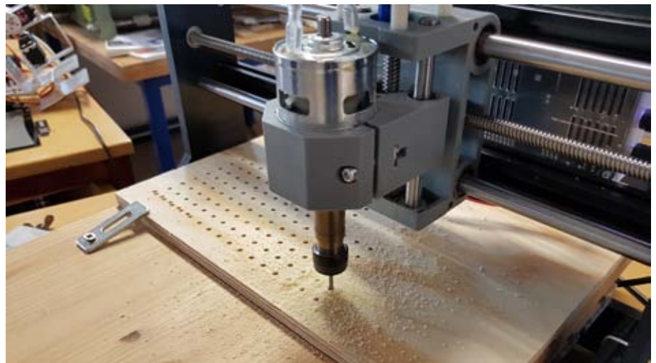
CNC Fräse beim Bohren der Löcher für den Vacuum Former
