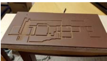
CNC Fräsentest einer Linoliumdruckform – noch per Handsteuerung
