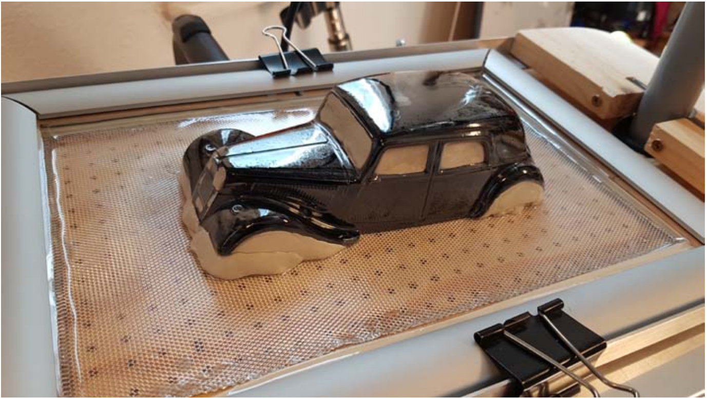
Vacuum Former: Ergebnis einer Abformung – Citroen T.A 15 CV
