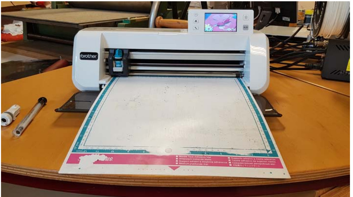
Der Schneideplotter, zum Schneiden und Plotten, auch mit stromleitfähiger Tinte
